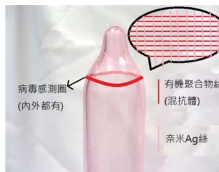
圖二 保險套外觀。保險套的單層布，是由奈米銀絲(粉紅垂直線)和聚合物絲(紅水平線)所編織成。而在病毒感測圈(上方紅色圓環)的有機聚合物絲再多加螢光有機抗體，當結合到病毒時會立即變色。
